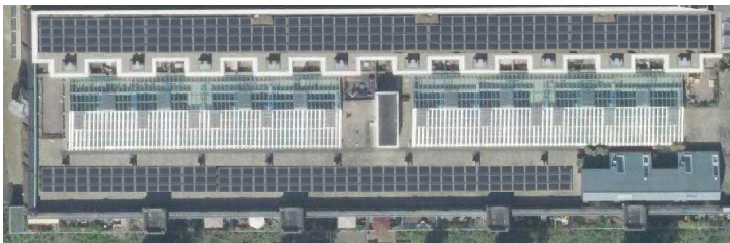
Legplan WO-DO: 370 panelen op het dak; 138 zuidzijde en 232 noordzijde
